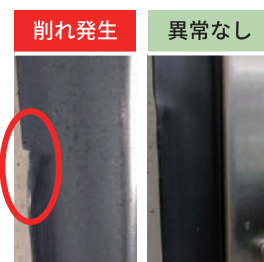
ドア側ガスケット (枠側下部) 開閉50万回時点 (左:他社品 右:当社品)
