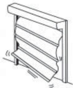
強風やシートへの衝突でレールよりパイプが外れた場合は、パイプ・シートをレールに入れ戻すことで使用できます。
