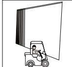
車輛、フォークリフトの通過箇所はなるべくハイパーADシート、ハイパーカーテンを設置し、シート・カーテンを解放後に通過して下さい。
