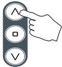
上昇ボタンを押し続け設定したい開口高さに到達したら上昇ボタンを離します。(1秒ブザー音)
