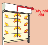
Hệ thống dây nối đất trên bề mặt màn sẽ ngay lập tức trung hòa tĩnh điện phát sinh.
