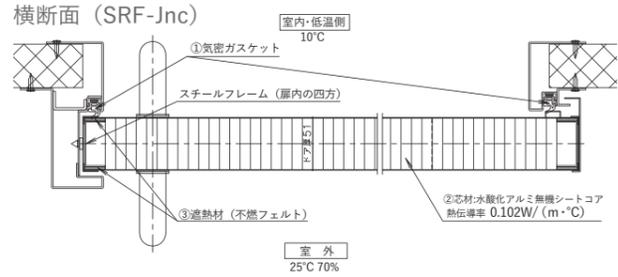
断熱性が高く中温度帯で扉表面が結露しにくい構造<sup>※</sup>です。結露が減ことで虫やカビの発生予防になり、清掃の手間軽減にもなります。
